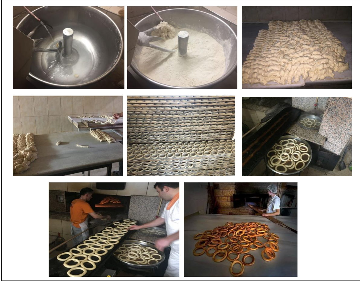
Şekil-1: Rize Simidinin Üretim Aşamaları
